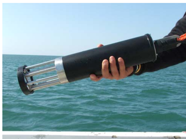
Fig. 2.6 - Sonda di velocità utilizzata per la misura della velocità del suono lungo la colonna d'acqua
