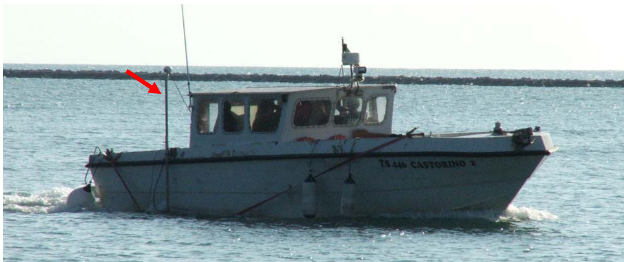
Fig. 2.3 – Il Castorino 2 in acquisizione. La freccia rossa indica il palo su cui è stato installato il Multibeam Reson SeaBat 8125.
